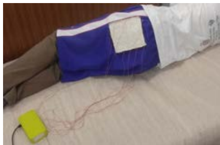
▲商品化を目指し実験を進めている床ずれ予防管理システムの繊維センサー
